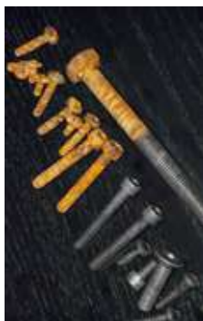
Remoción de óxidos, limpieza y pintura
